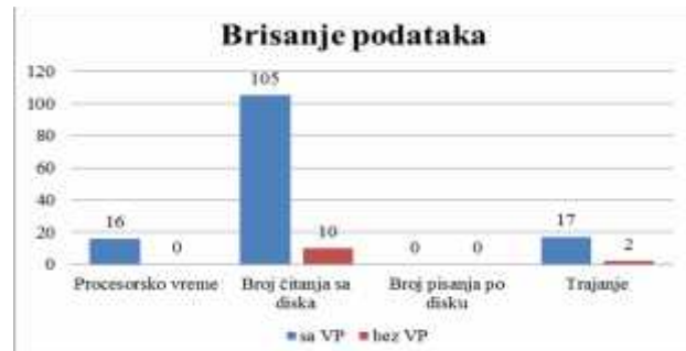
Slika 3. Grafi ki prikaz rezultata merenja pri brisanju podataka sa i bez primene vertikalnog particionisanja
