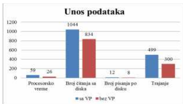
Slika 1. Grafik prikazuje rezultate merenja pri unosu podataka sa i bez primene vertikalnog particionisanja
