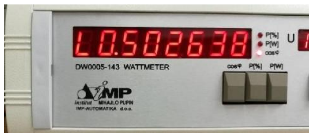
Slika 5. Merenje faktora snage – induktivno opterećenje
