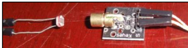
Slika 3. Laser sa fotootpornikom
