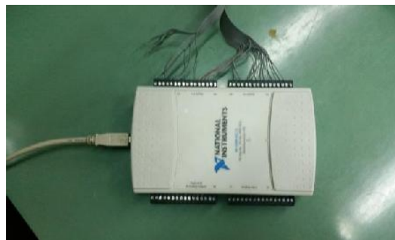
Slika 7. Akvizicijska kartica NI USB 6212 sa povezanom magistralom komunikacije
