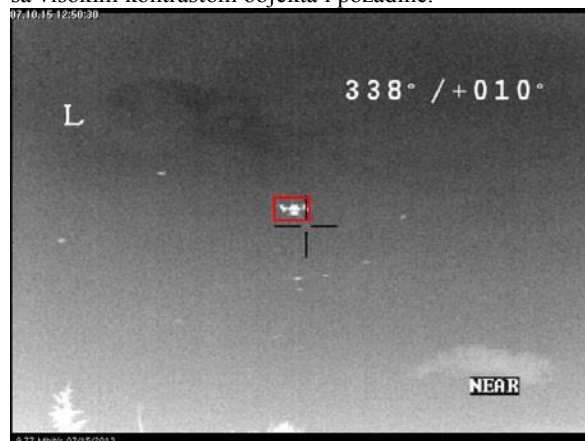
Slika 8. Praćenje multikoptera sa objektima u pozadini.
