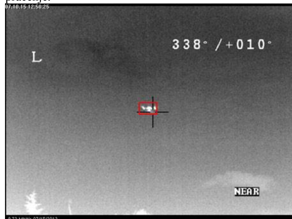
Slika 7. Praćenje multikoptera termovizijskom kamerom sa visokim kontrastom objekta i pozadine.
