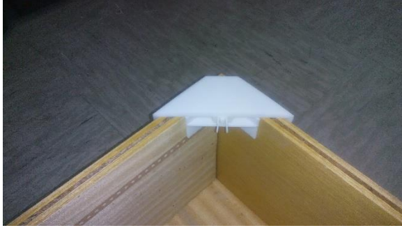
Slika 11. Primer primene alata za spajanje 2 drvene ploče
