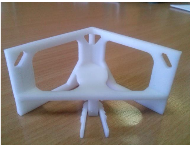
Slika 18. Fizički model elementa 2 nakon optimizacije
