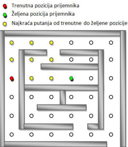
Slika 3. Prikaz proračuna najkraće putanje do željene lokacije primenom Dijkstra algoritma
