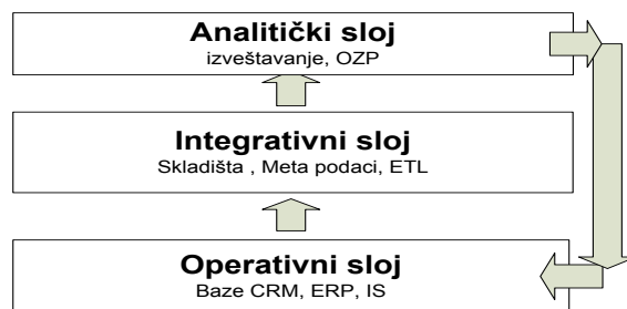
Slika 3. Struktura sistema PI
