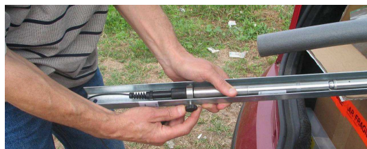
Slika 5. Merna sonda za limnimetrijsko merenje vodostaja
