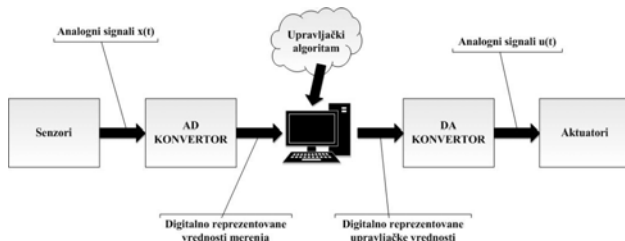
Slika 1. Uprošćena blok šema računarski baziranog upravljačkog sistema
