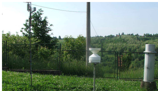
Slika 2. e+ RAIN pluviograf na stanici „Ripe“ sa drugim meteorološkim instrumentima
