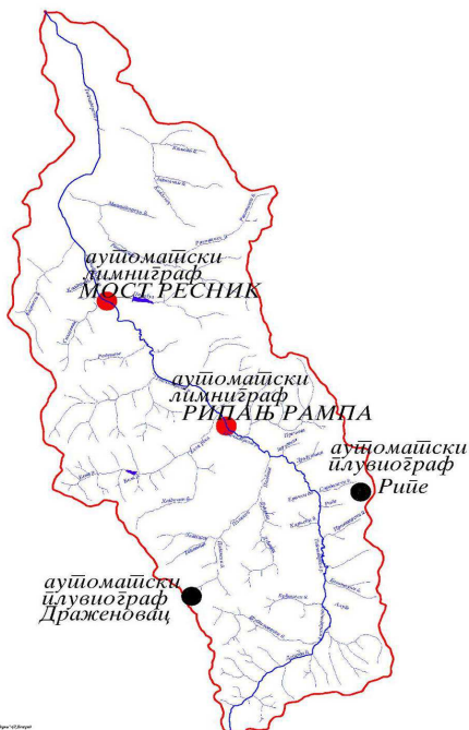
Slika 1. Sliv Topčiderske reke sa instaliranom opremom za praćenje kiše i poplava
